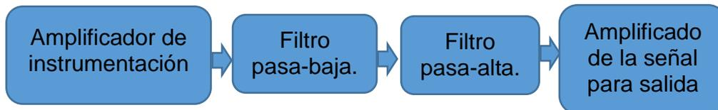
Figura 3.3 Diagrama a bloques de Acondicionamiento de la señal.
